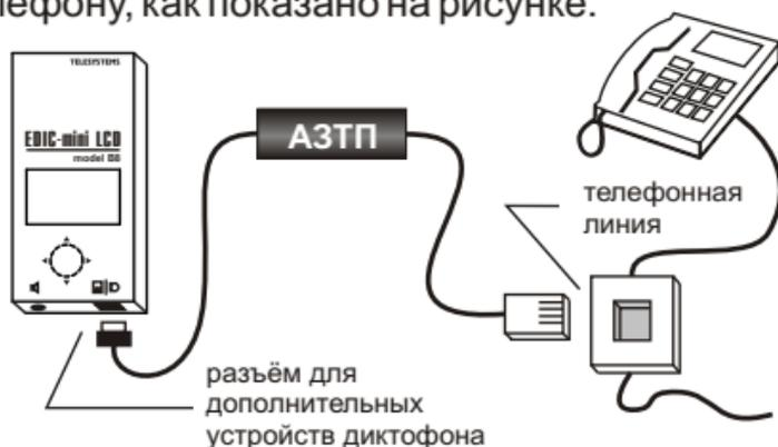
После этого диктофон будет автоматически включаться на запись при поднятии трубки телефона и отключаться при ее опускании.
